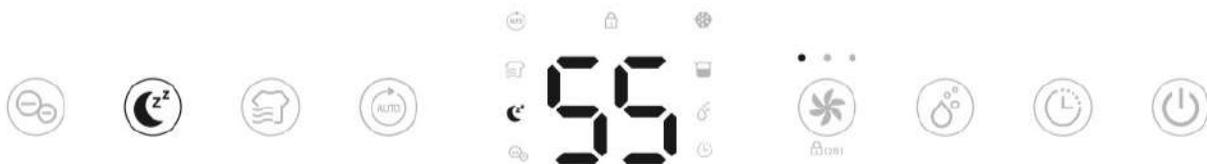
Πιέστε το πλήκτρο ύπνου για να ενεργοποιήσετε τη λειτουργία. Η συσκευή λειτουργεί στο **55% σχετικής υγρασίας** και **στη χαμηλή σκάλα ανεμιστήρα**. Όλες οι ενδείξεις θα σβήσουν 5 δευτερόλεπτα μετά την ολοκλήρωση της ρύθμισης. Αγγίξτε οποιοδήποτε πλήκτρο για να ενεργοποιήσετε και πάλι το φωτισμό στον πίνακα ελέγχου και να λειτουργήσετε τη συσκευή ως συνήθως.
