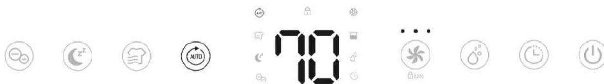
Πιέστε το πλήκτρο Auto για να ενεργοποιήσετε τη λειτουργία αυτόματης αφύγρυνσης. Η συσκευή δουλεύει αυτόματα βάσει της Σχετικής Υγρασίας χώρου που ανιχνεύει και σύμφωνα με τον παρακάτω πίνακα.
